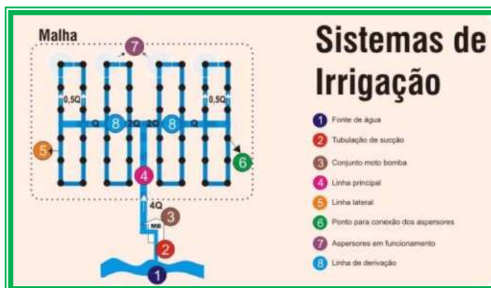
Sistema de irrigação em malha: menor custo de implantação e maior eficiência
