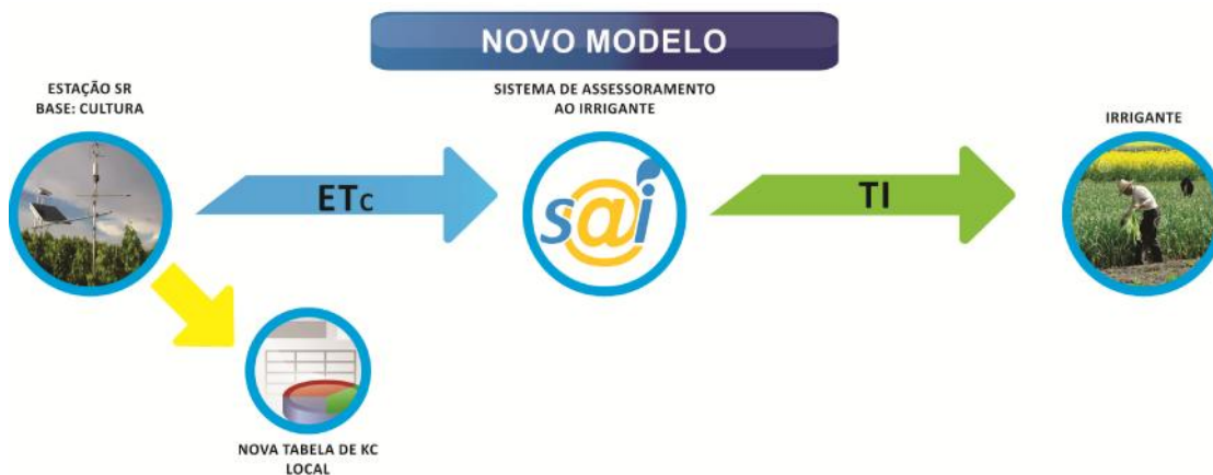
Figura 14. Novo Modelo proposto de determinação da ET_c e do Tempo de Irrigação (TI) com a aplicação da tecnologia SR e a utilização do Sistema S@I.
