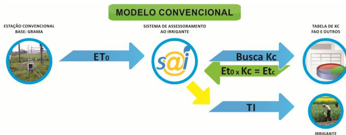
Figura 13. Modelo convencional de determinação da ET_c e do Tempo de Irrigação (TI)
