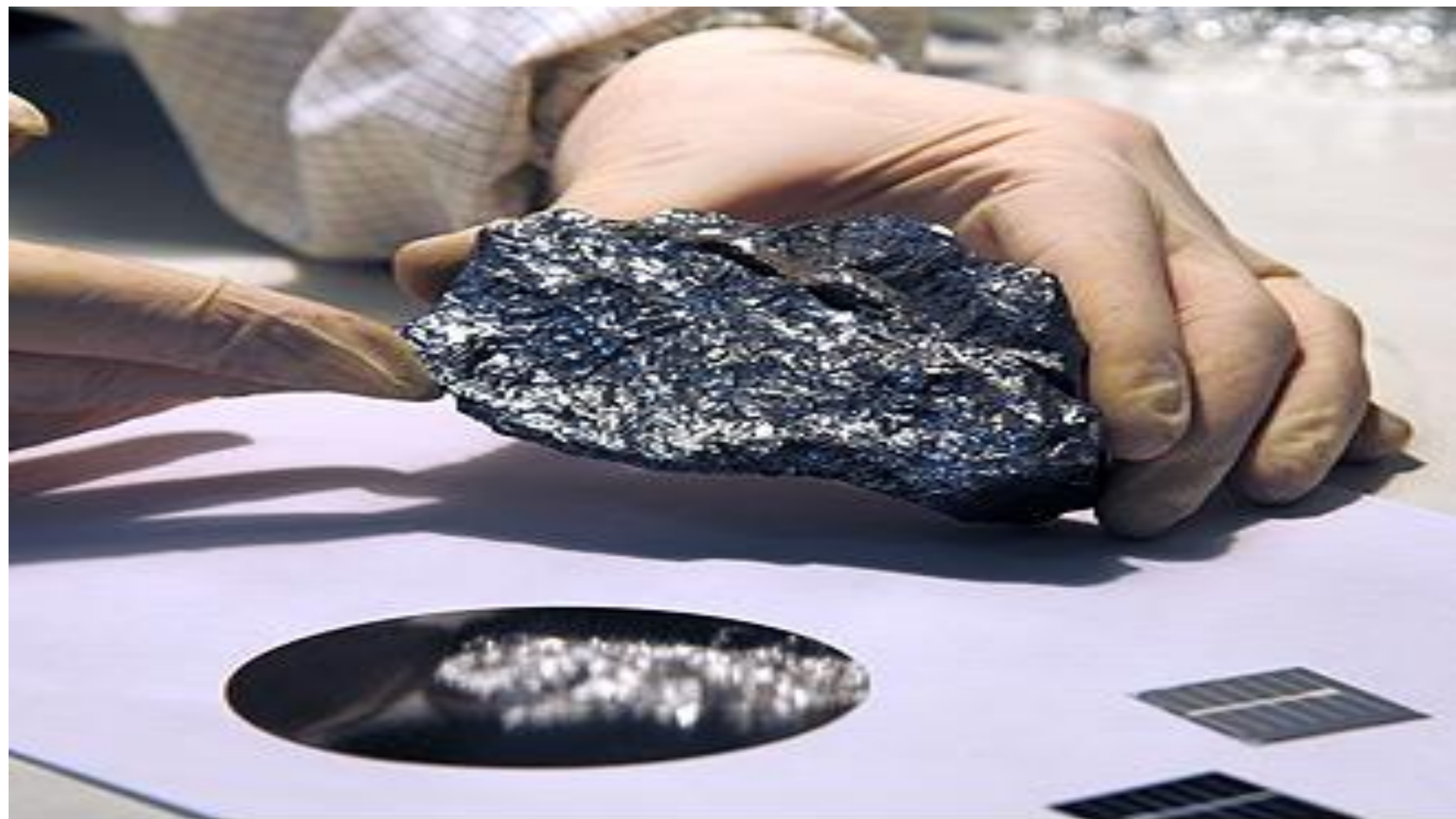
O silício metalúrgico, a lâmina (centro) e as células solares (à dir.)
